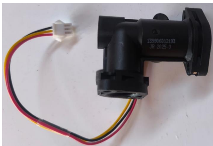
Imagem 5 - Sensor de vazão tipo turbine
