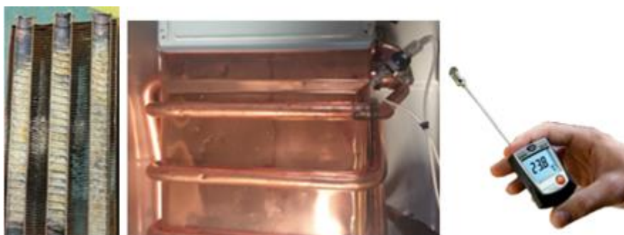
Imagem 17 - Exemplo de medição da temperatura do trocador de calor
