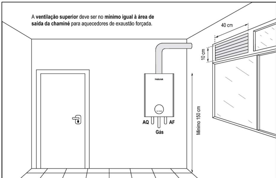
Fig. 11 Instalação em área de serviço – Exaustão forçada
