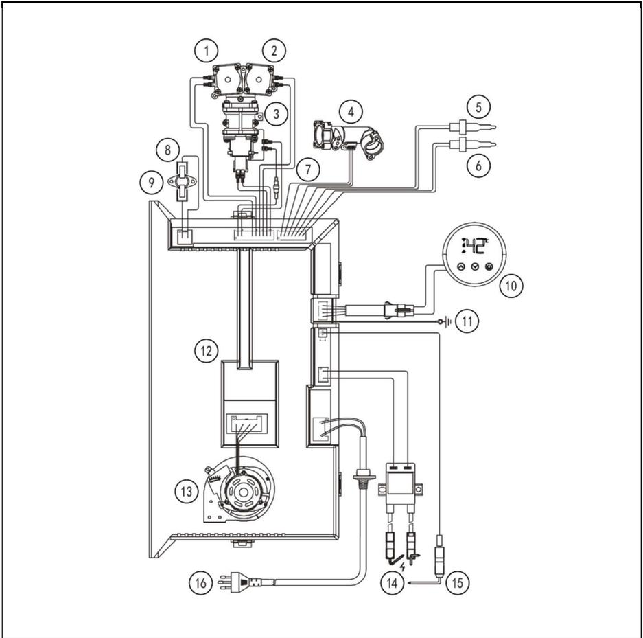
Fig. 7 Esquema funcional GWE-26
