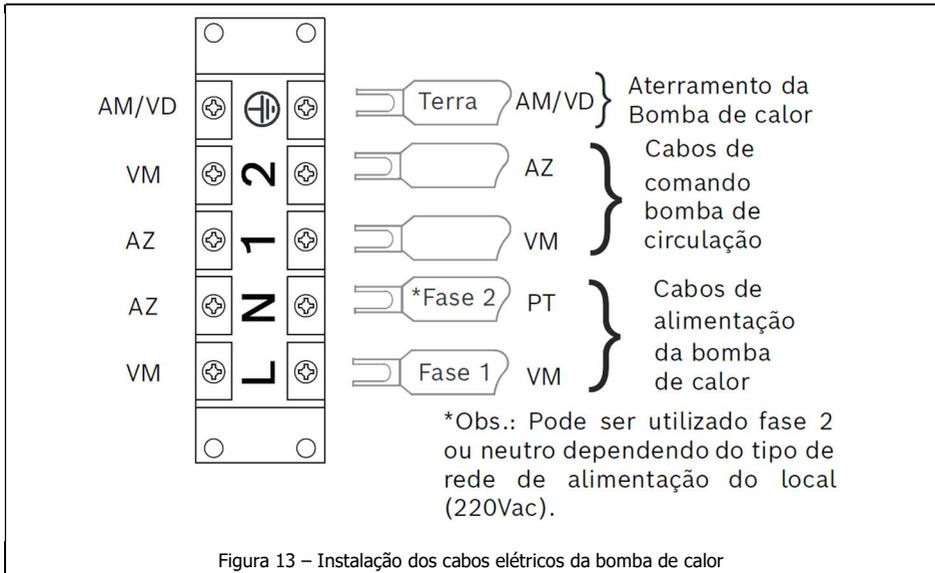
Após executar a instalação elétrica aperte o parafuso do prensa cabos, para garantir a fixação dos cabos elétricos ao terminal.
