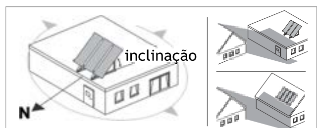
Fig. 8 - Orientação e inclinação dos coletores solares
