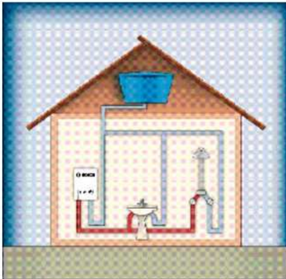
Instalação utilizando caixa d'água
