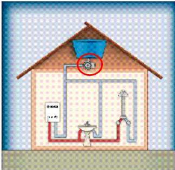
Instalação com pressurização na rede hidráulica
