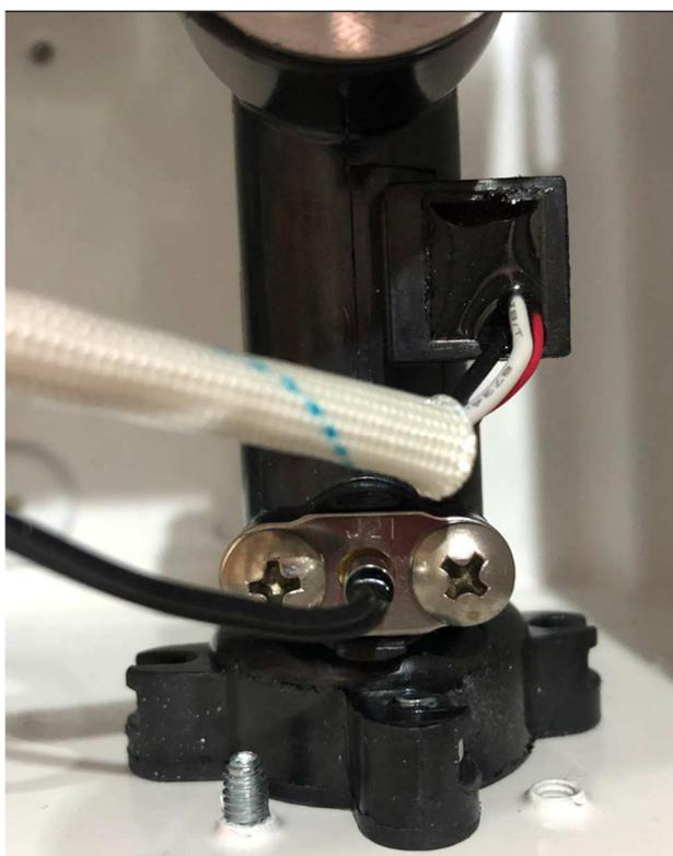
Imagem 4 – Sensor de vazão tipo turbine
