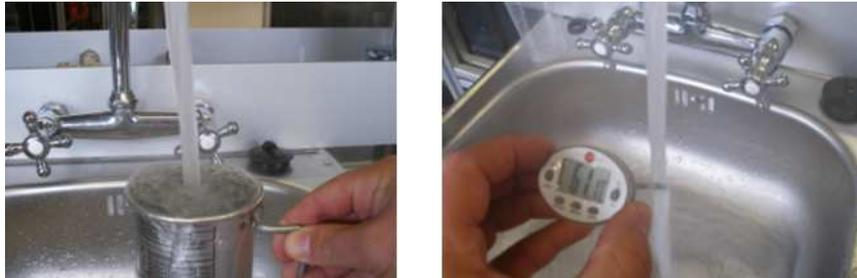
Imagem 1 - Utilização do medido de vazão e termômetro
