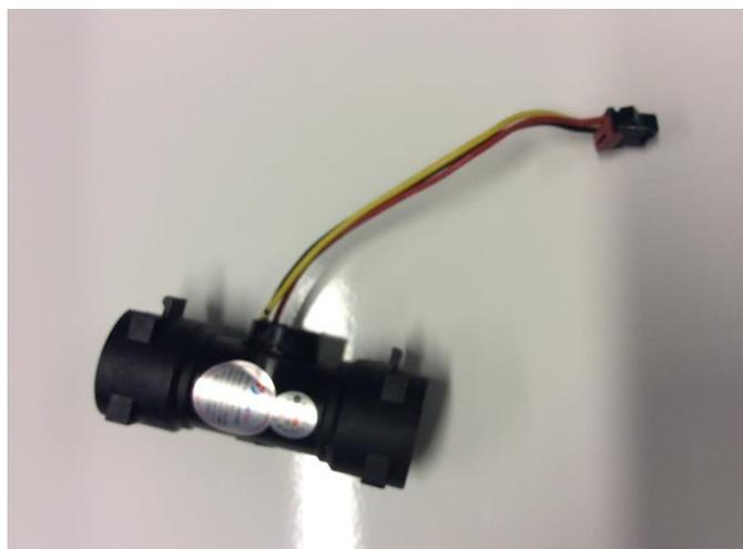
Imagem 3 – Sensor de vazão tipo turbine
