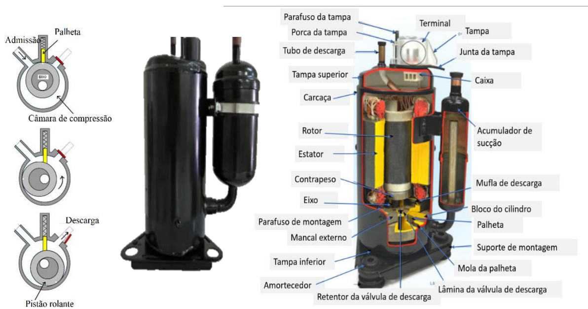
Figura 1 – Detalhes do compressos de palheta estacionária
