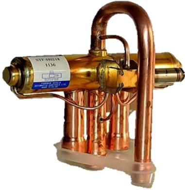
• Permite que o equipamento funcione na função **Aquecimento e Resfriamento**, a placa eletrônica manda um sinal para solenoide, que altera a passagem do gás, forçando um embolo, mudando a direção do gás no tubo de descarga da válvula.
