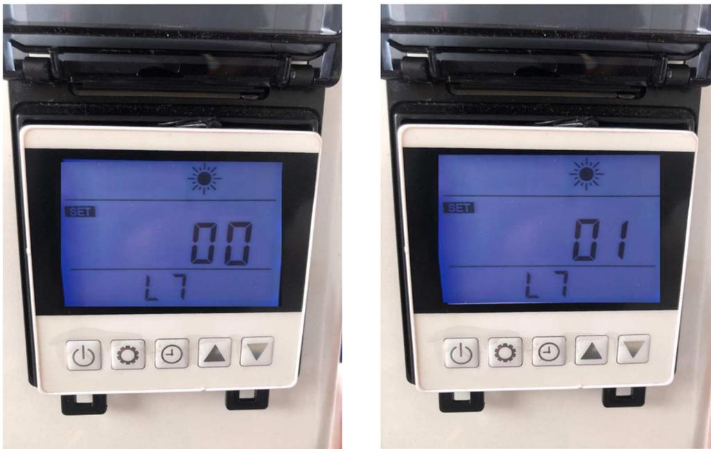
Ao acessar os parâmetros de configuração da bomba de calor, o parâmetro L7 possui duas opções:
