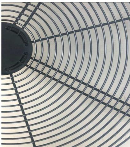
Após lixar a superfície oxidada, limpe-a utilizando um pano seco ou embebido de solvente, pode-se utilizar querosene para a limpeza da peça.
