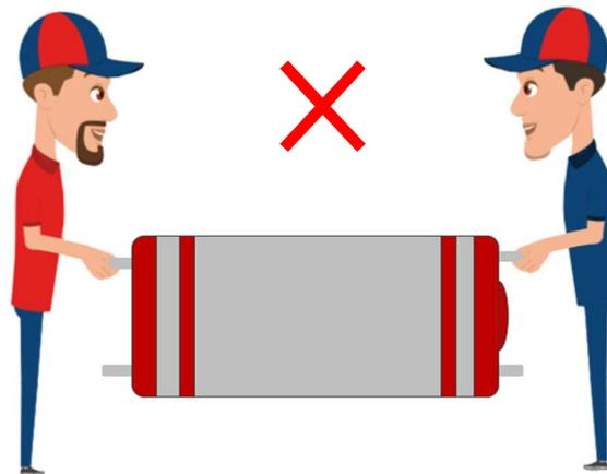
Ao invés de carregar o reservatório térmico através dos tubos opte por carregar ele pela parte inferior, e se houver a necessidade de içar, utilize o corpo do reservatório, deste modo, você evita possíveis danos.
