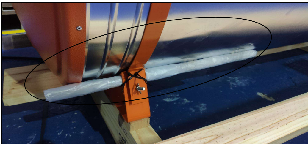
Figura 1 - ânodo fixado no pé
