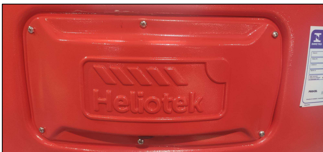
Figura 12 - Recolocar tampa de ABS
