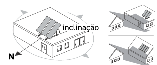
Fig. 8 - Orientação e inclinação dos coletores solares
