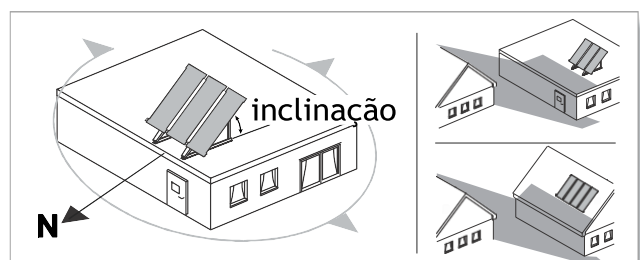
Fig. 8 - Orientação e inclinação dos coletores solares
