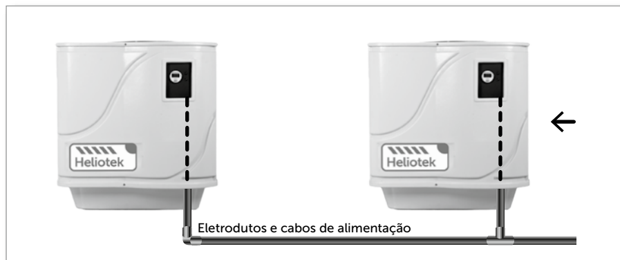
Figura 6 – Alimentação da bomba de calor
